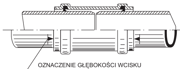
Rys. 21. Łączenie bosych końców rur za pomocą mufy przesuwnej KGU
