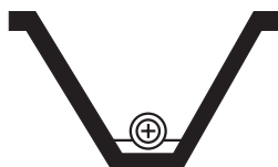
Wykop o ścianach spadzistych
